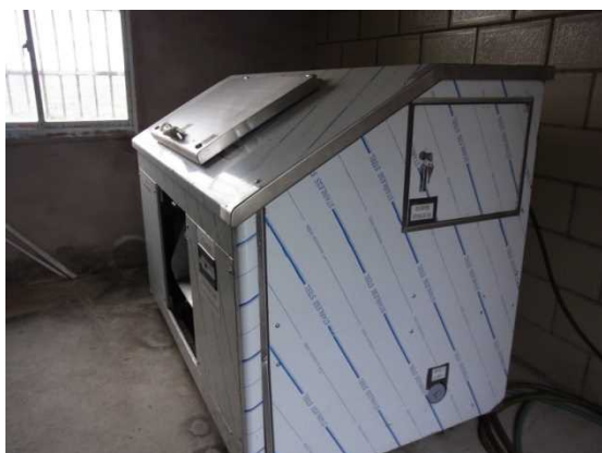
「汚水処理支援等による農民の生活環境改善事業」（平成 22 年度日本 NGO 民間連携無償資金協力）で設置したコンポスター（有機廃棄物を有機肥料へ転換する装置）
